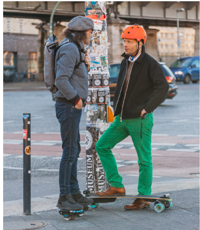
Bild 5: Hovershoes (links) fahren bis zu 12 km/h schnell und haben eine Reichweite von etwa zehn Kilometern. (Quelle: Bundesverband für Elektrokraftfahrzeuge e.V.)
