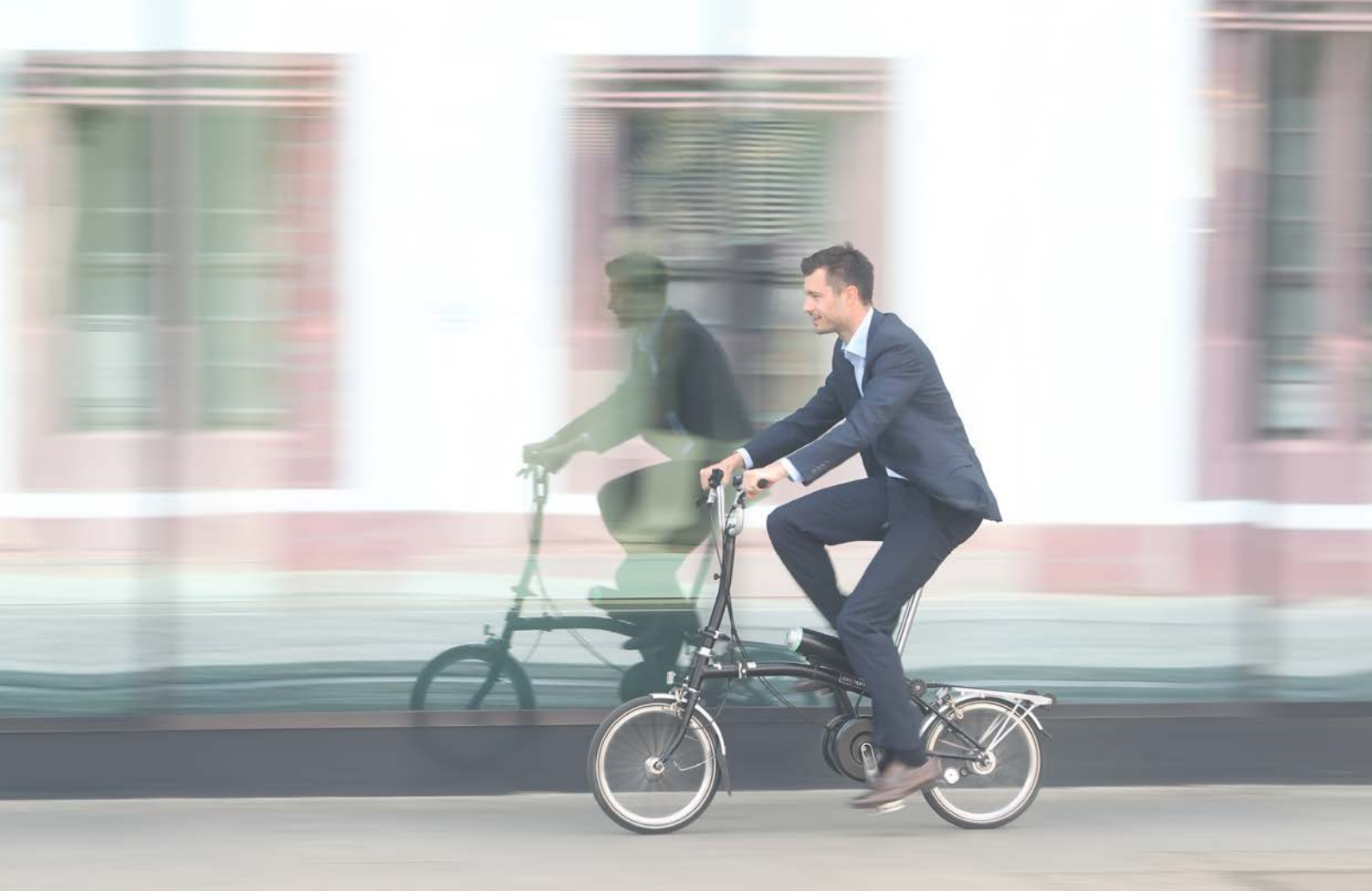
Bild 1: Selbst Falträder, hier ein Brompton , lassen sich mit einem Aufrüstsatz, in diesem Fall von Pendix , umbauen. (Quelle: Pendix )
