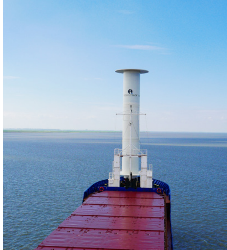
Bild 4: Der Flettner-Rotor kommt im Betrieb auf ca. 260 Umdrehungen pro Minute. (Foto: Martin Bönsch)
