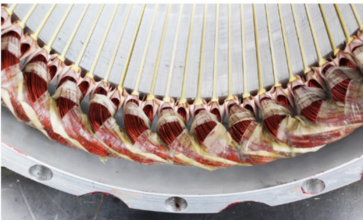
Bild 2: Wickelkopf einer Permanentmagnet-erregten Elektromaschine für Nutzfahrzeuge mit 300/600 kW Dauer-/Spitzenleistung. (Quelle: Prof. Dr. Ulrich Schrade)
