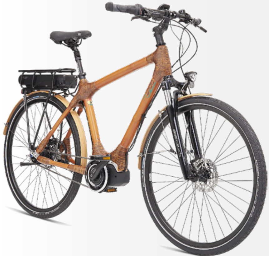
Bild 1: my Volta – das erste my Boo-Pedelec aus Bambus mit integriertem Mittelmotor. (Quelle: my Boo GmbH)
