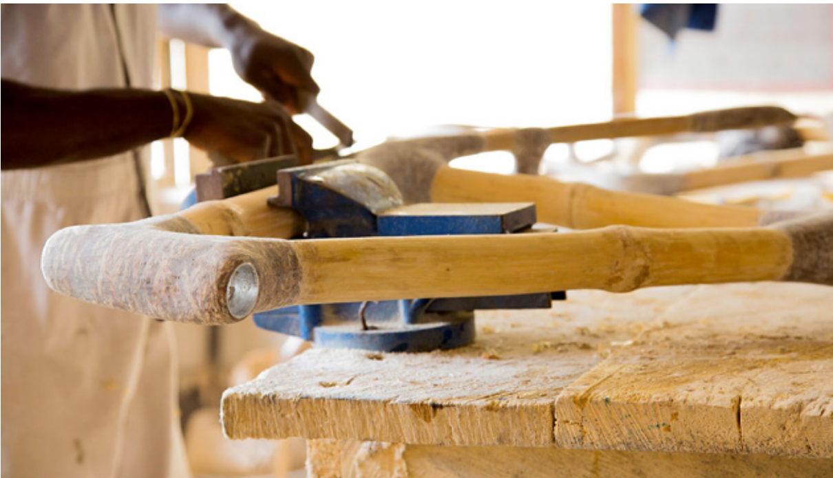
Bild 4: Jedes Bambusfahrrad ist ein Unikat und wird in etwa 80 Stunden Handarbeit gefertigt. (Quelle: my Boo GmbH)
