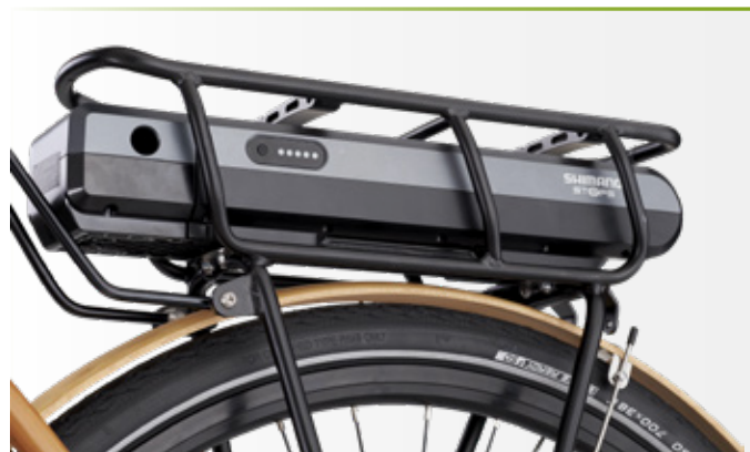
Bild 5: Der 416-Wh-Akku befindet sich unter dem Gepäckträger und bietet laut Hersteller eine Reichweite von bis zu 120 Kilometern. (Quelle: my Boo GmbH)
