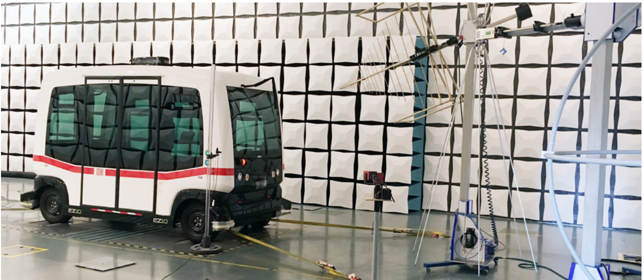
Bild 2: Das Shuttle wird verschiedenen Emissionen (Frequenzen) ausgesetzt und die Störaussendung sowie Störfestigkeit gemessen. (Quelle: TÜV SÜD)
