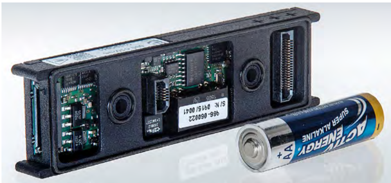
Bild 2: Ein MCM-IntelliProbe -Messmodul ist extrem kompakt gebaut, bietet aber trotzdem eine Isolationsfestigkeit bis 1.400 Volt. (Quelle: Emanuel Zifreund/Smart Testolutions)
