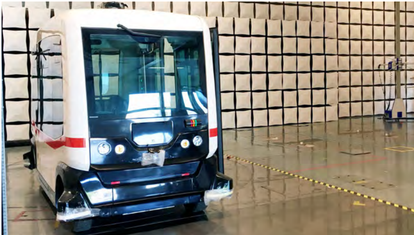
Bild 4: Prüfung zur Elektromagnetischen Verträglichkeit (EMV) des EZ10 in der Absorber-Kammer des EMV-Labors von TÜV SÜD Senton in Straubing. (Quelle: TÜV SÜD)
