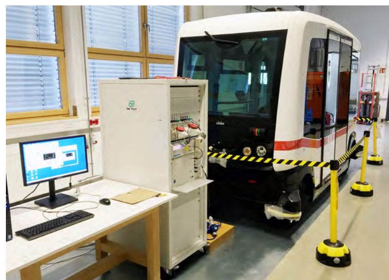
Bild 3: Im Ladebetrieb – EMV-Prüfung beim EZ10. (Quelle: TÜV SÜD)
